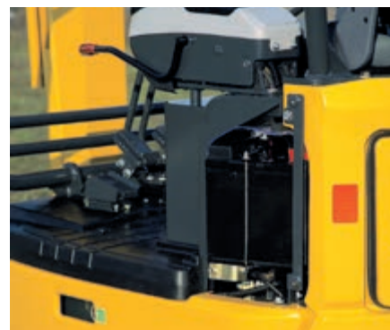
Levá kapota: snadný přístup k akumulátoru
